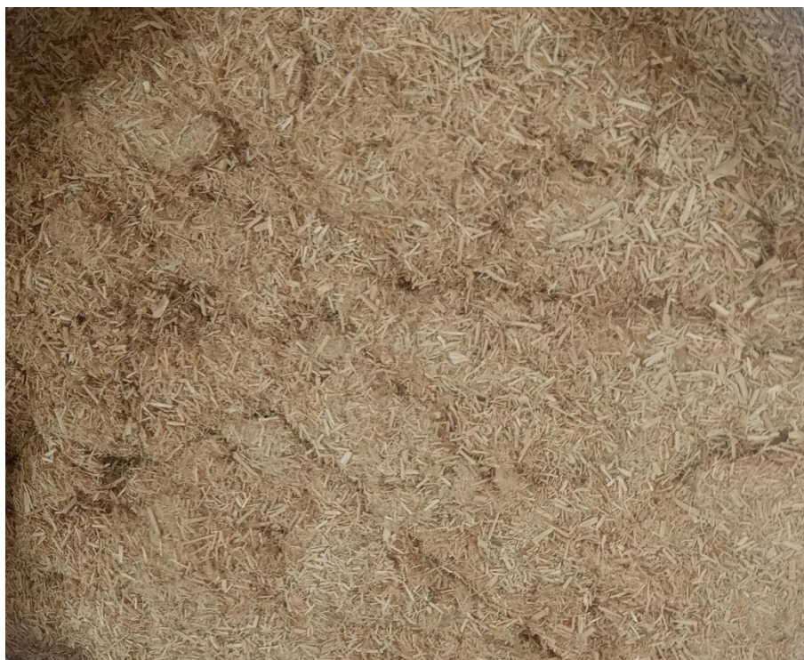
Figura 7 – Bagaço de cana-de-açúcar bruto recebido do Laboratório Nacional de Biorrenováveis (LNBR), antes do processo de moagem.
