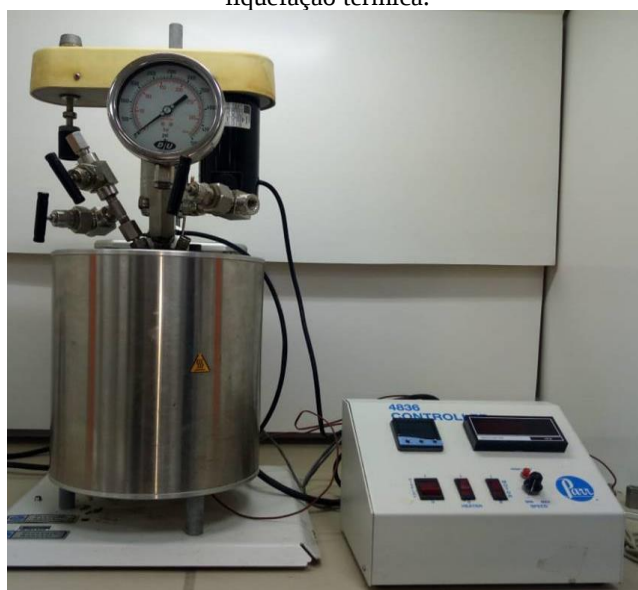
Figura 8 – Reator Parr 4576 usado no processo de liquefação térmica.
