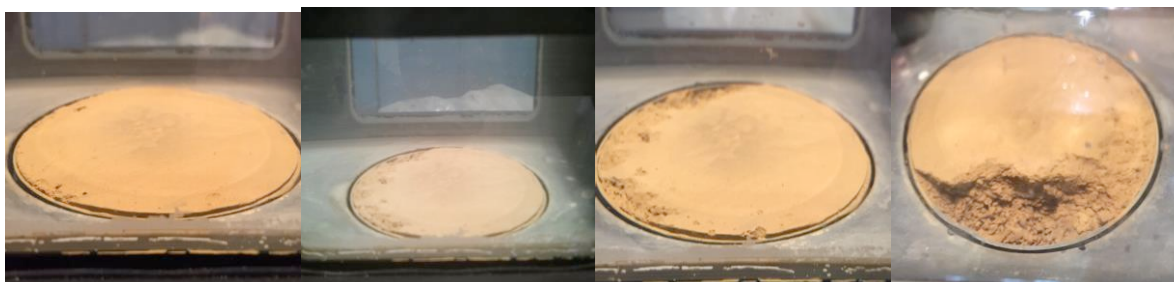
Figure 37 : l'évolution de l'érosion pendant la réalisation d'un essai EFA
