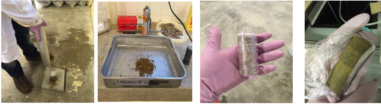
Figure 16: réalisation d'un échantillon pour l'essai triaxial
