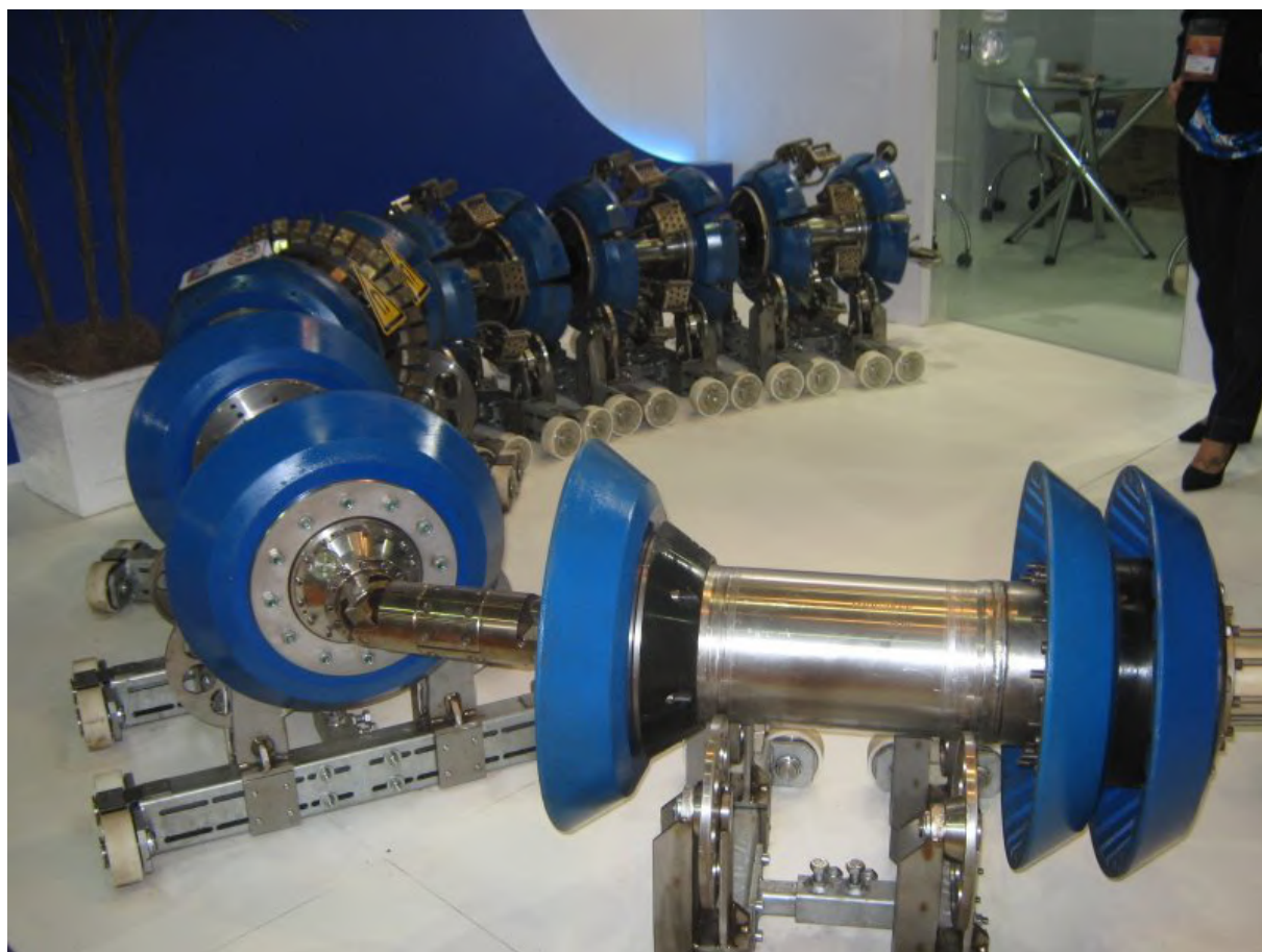
Figura 9 – Ilustração de um pig de inspeção ultrassônica.
