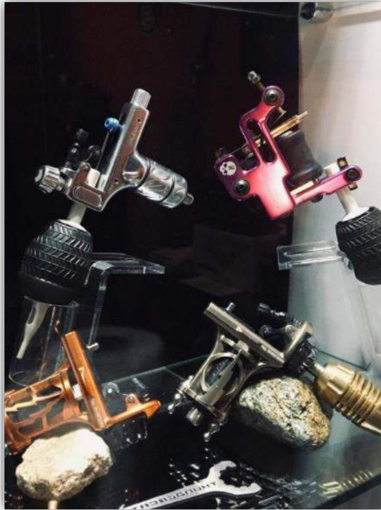
*Figura 2 Máquinas rotativas do tipo direct (as duas prateadas e a laranja) e uma máquina de bobina híbrida (rosa).*
