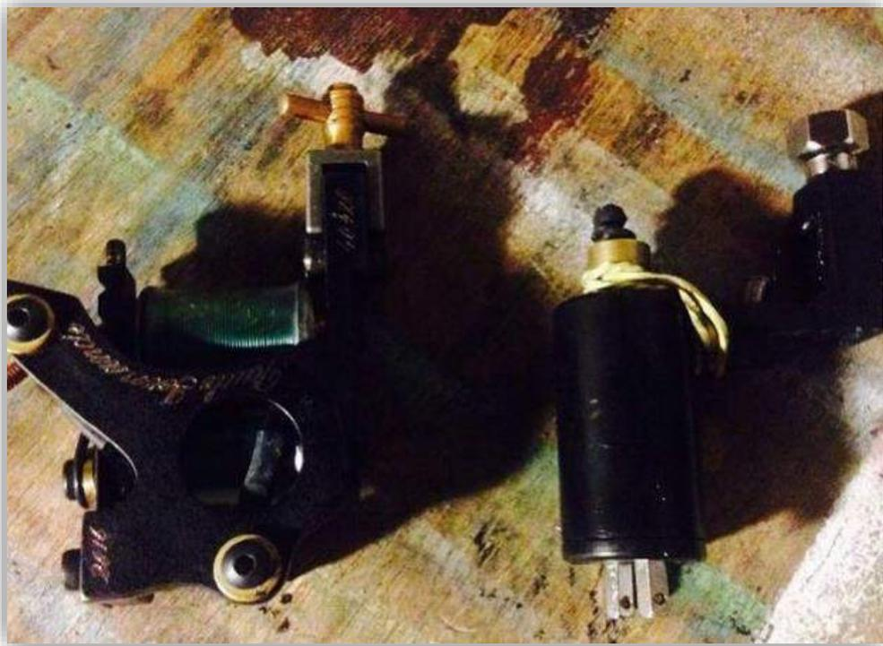
*Figura 4 Máquina de bobina walker line (direita), máquina utilizada para traços. Máquina rotativa chinesa do tipo direct (esquerda) utilizada para preenchimentos e sombreados.*
