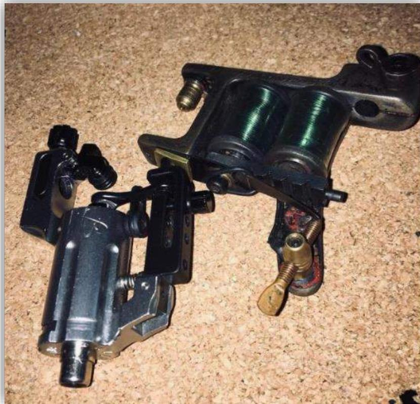
*Figura 1 Máquina rotativa a esquerda (bala machine), máquina de bobina a direita (bulldog para traço).*
