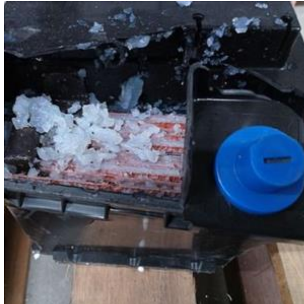
Figura 3 - Construção bateria GEL VRLA
