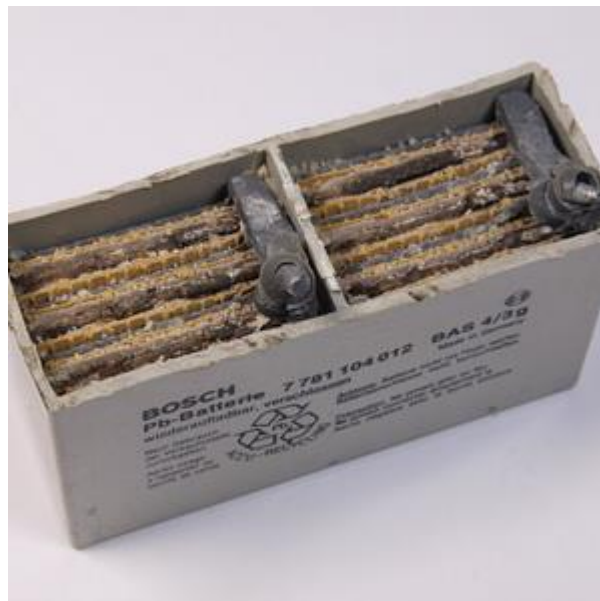
Figura 2 - Construção bateria AGM VRLA
