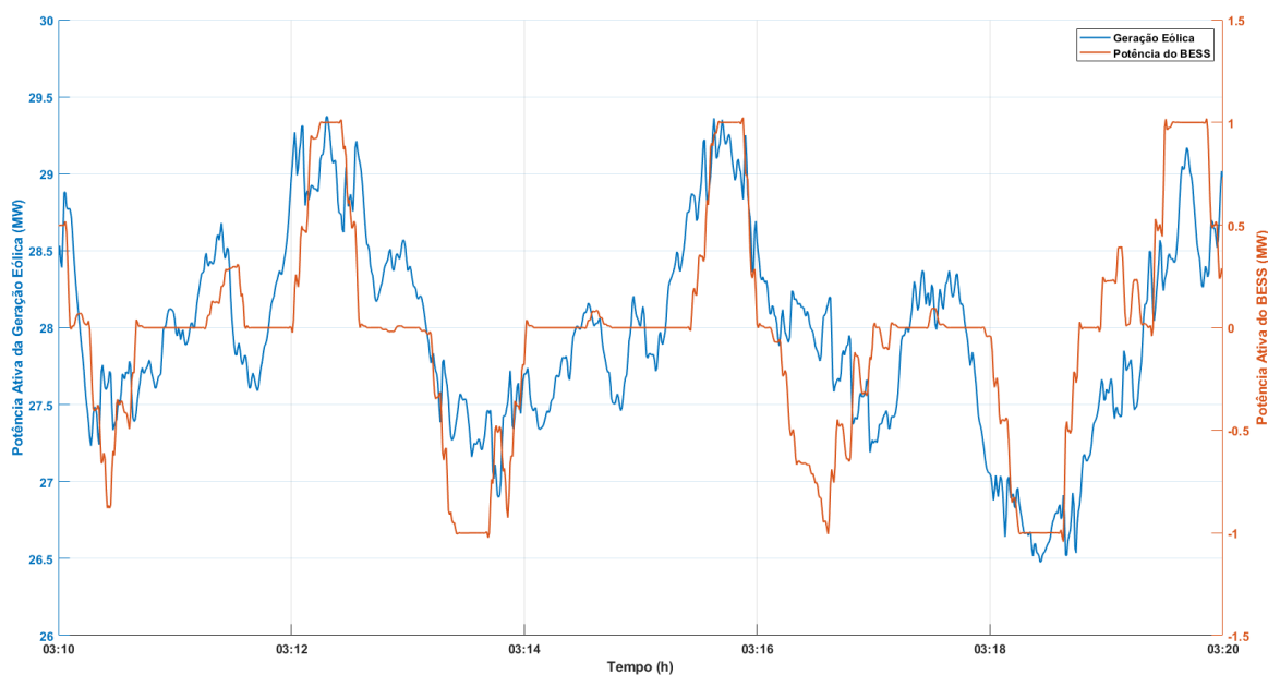
Figura 28 – Operação do BESS a partir da Variação de Potência Ativa da Geração Eólica (1º Dia).
