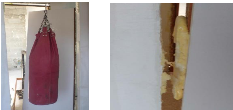
Figura 37 e 38: Falhas no ensaio de fechamento na porta 3.
