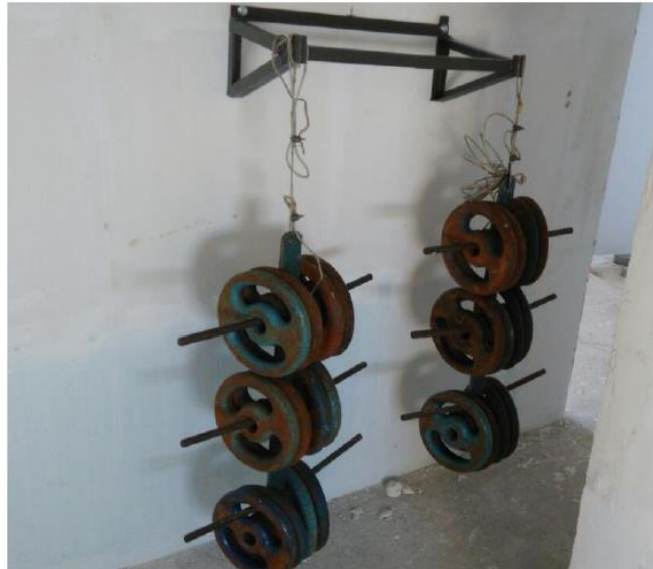
Figura 39: Final do ensaio de carga suspensa utilizando mão francesa padrão com carregamento de 120kg.
