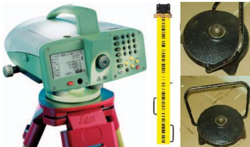
*Figura 10 - Nível digital Leica modelo DNA03, mira de código de barra invar e duas sapatas.*
