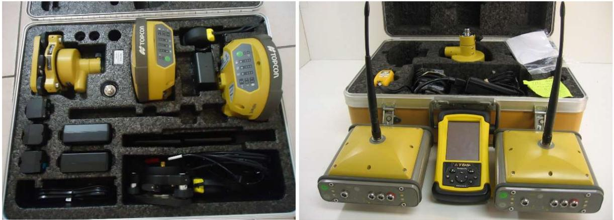
*Figura 11 - Receptores Topcon Hiper V e Hiper Lite.*
