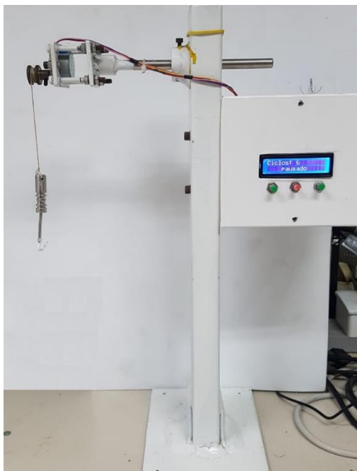
Figura 8 – Máquina de washcoating de fabricação do grupo de pesquisa.
