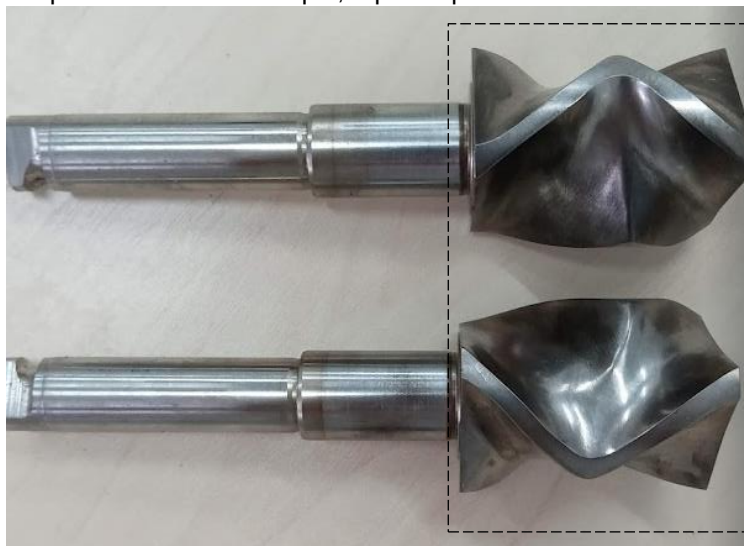
Figura 7 – Rotores tipo "roller". Em destaque, a parte que fica em contato com a amostra
