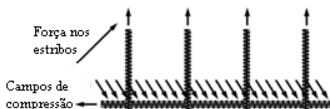
Figura 2-2 Adaptação de Mörsch da treliça de Ritter (MÖRSCH, 1902).
