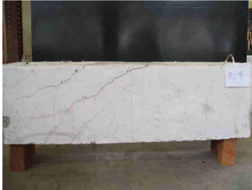
Figura 7-1 Ensaio experimental do bloco 4 por Araújo et al (2007)
