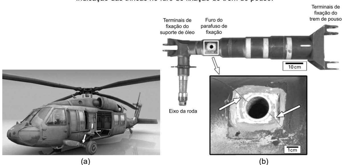
Figura 1 – Exemplo de EAC: (a) Localização do trem de pouso principal esquerdo do helicóptero; (b) Indicação das trincas no furo de fixação do trem de pouso.
