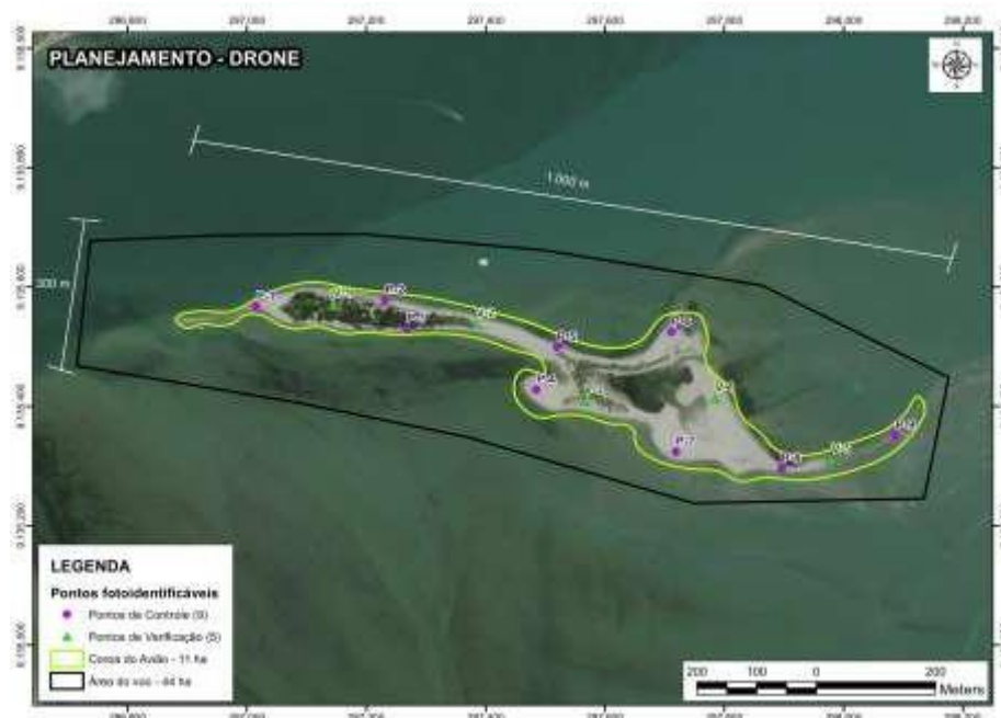
Figura 11 - Distribuição dos pontos de apoio e controle.
