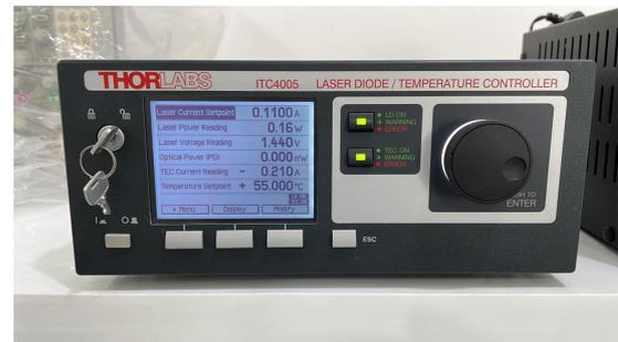
(b) Dispositivo de controle de temperatura e corrente ITC4005.
