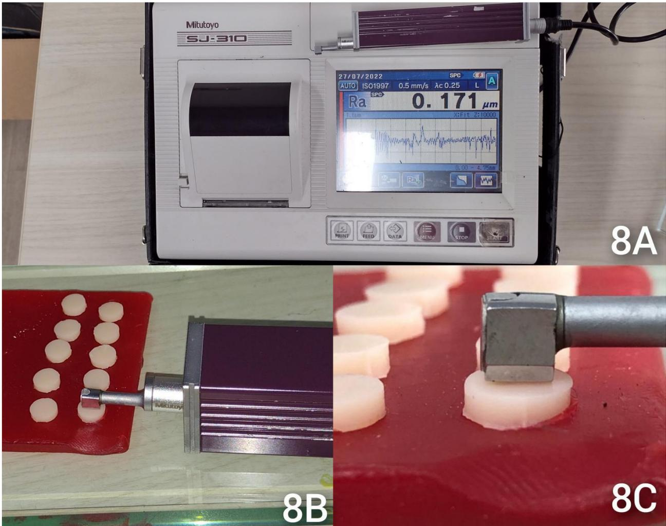
**Figura 8-** 8A: Rugosímetro SURFTEST SJ 310, Mitutoyo Corp, Kanagawa, Japão; 8B: Medição da rugosidade das amostras em diferentes direções; 8C: Interface amostra e ponta apalpadora (Pick up). **Fonte:** O Autor (2022).
