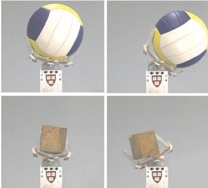
Figura 5 – Garra com diferentes objetos e variação de posição
