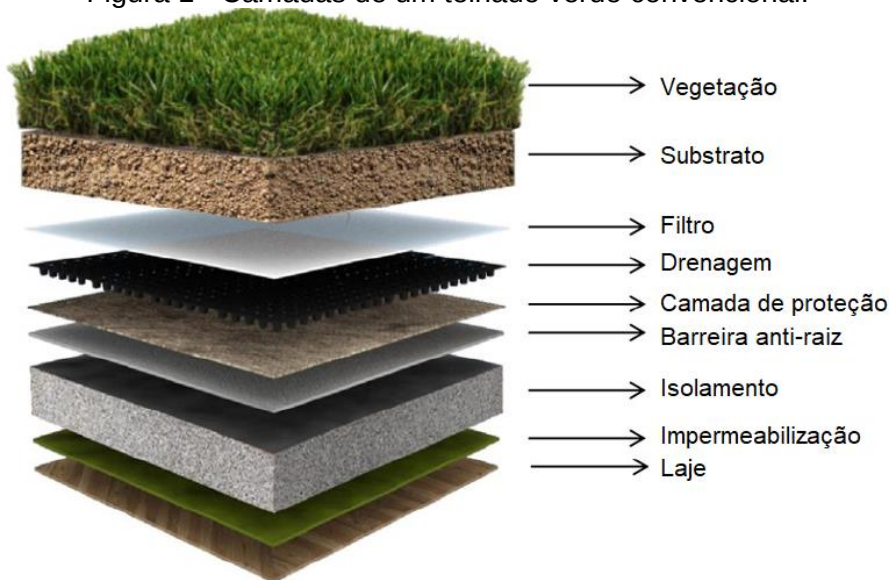
Figura 1 - Camadas de um telhado verde convencional.
