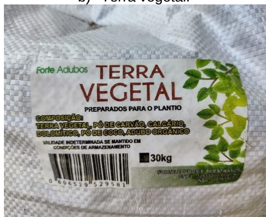
Figura 9 - Componentes do substrato utilizados nos telhados.
