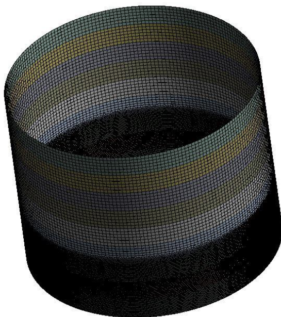
Figura 19 – Visão geral da malha gerada na Análise I
