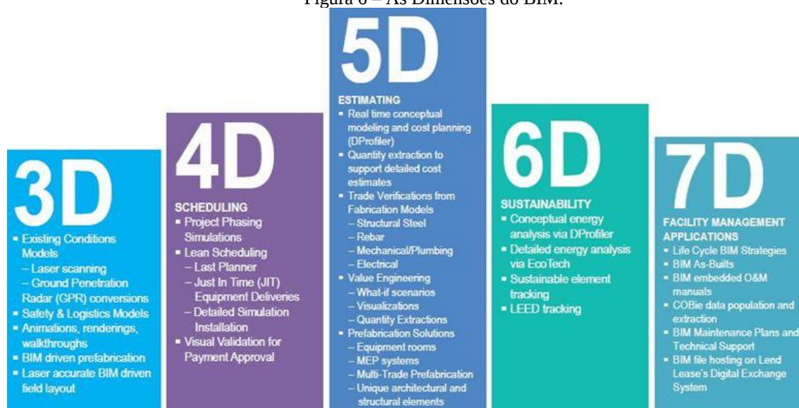
Figura 6 – As Dimensões do BIM.
