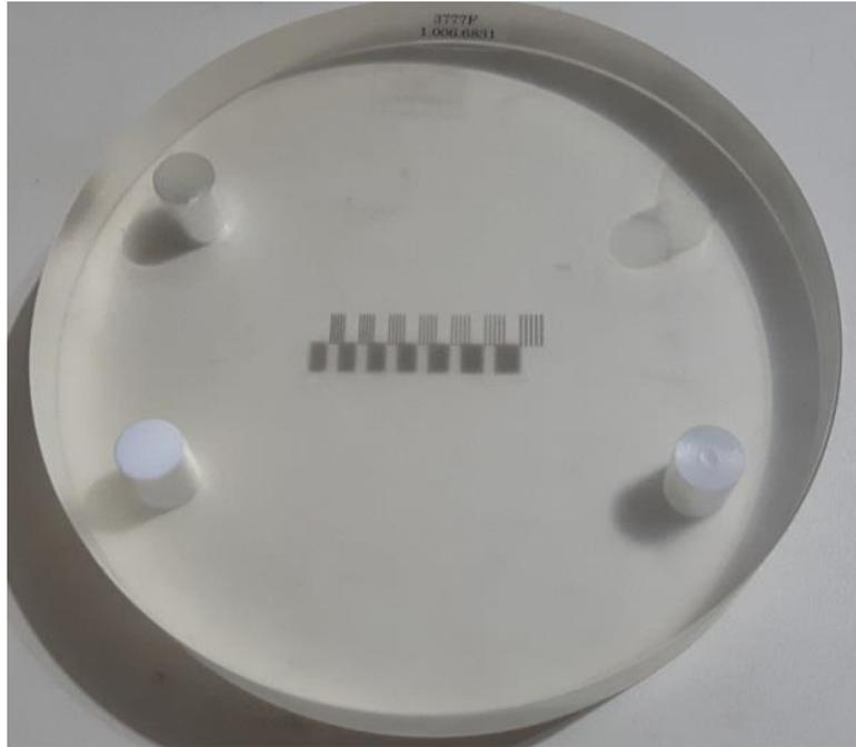
Figura 3 - O simulador de controle de qualidade consiste em uma placa cilíndrica de acrílico contendo padrões de barra metálicos no centro.
