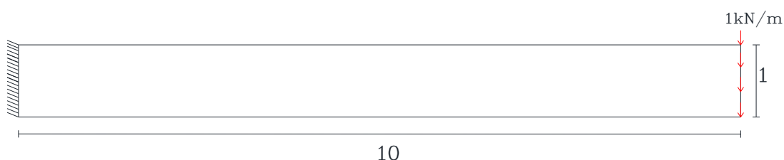
Figura 34- Apresentação do problema da viga engastada em balanço.
