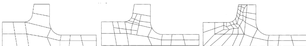
Figura 10- Comparação entre as malhas: Original, Subdivisão de elemento e Regeneração, respectivamente.
