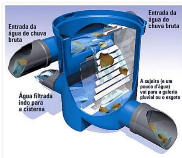
Figura 12 - Filtro para telhados de até 200 m 2 .
