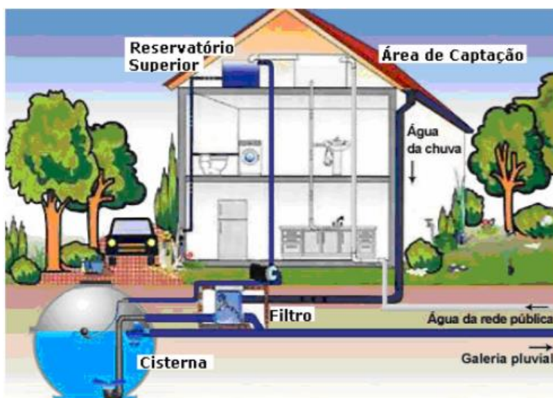
Figura 3 - Esquema de funcionamento de sistema aproveitamento de água de chuva (BELLA CALHA, 2007 apud MARINOSKI, 2007).
