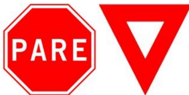
FIGURA 7 – Exemplo de sinalização vertical de regulamentação.
