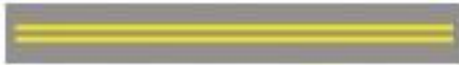
FIGURA 11 – Exemplo de sinalização horizontal com a finalidade de não permitir ultrapassagem.
