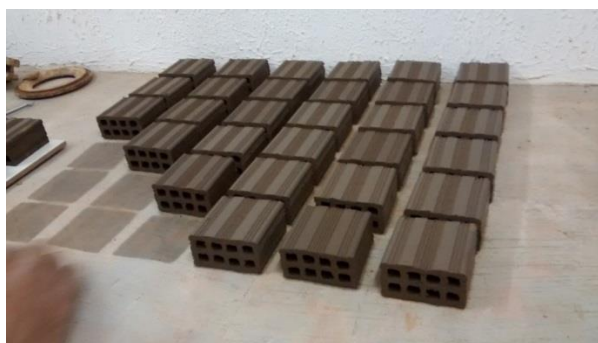
Figura 3.17 - Corpos de prova secando ao ar livre
