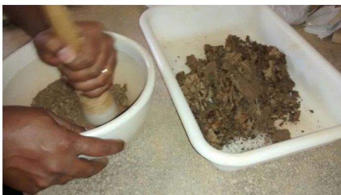
Figura 3.8 - Destorroando o Material
