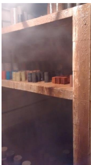
Figura 3.21 - Cura do Corpos de Prova
