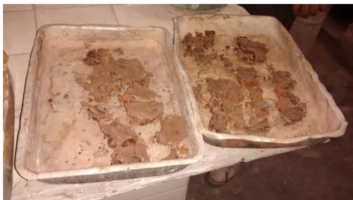
Figura 3.4 - Lodo seco nas fôrmas
