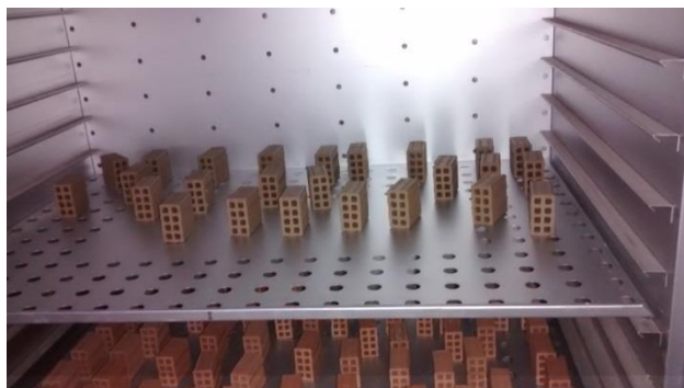
Figura 3.18 - Corpos de prova secos em estufa
