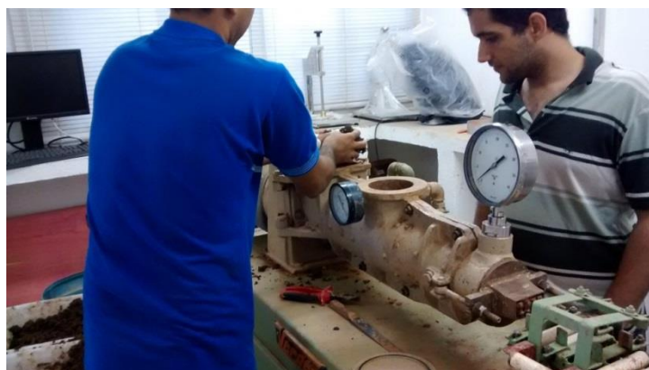
Figura 3.12 - Extrusora para fabricação dos tijolos
