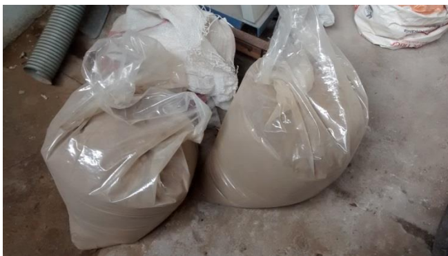
Figura 3.15 - Acondicionamento da argila triturada
