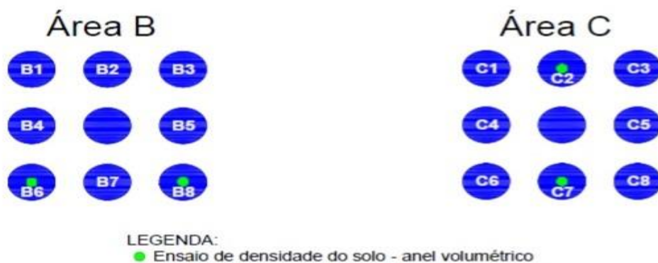
Figura 17 - Representação esquemática da locação dos pontos onde foram realizados os ensaios de peso específico do solo.
