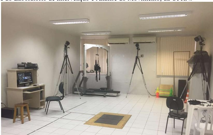
É possível observar três das seis câmeras para captura de movimento e as duas plataformas de força embutidas no piso. Fonte: elaborado pela autora.
