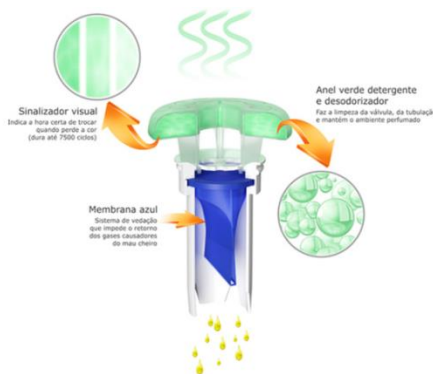
Figura 27 - Cartucho do mictório Save Design do fabricante DECA.
