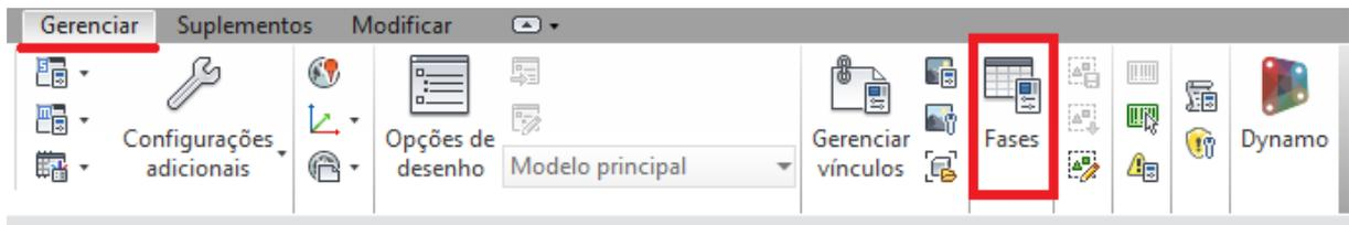
A janela Fases do Projeto (figura 21) apresenta duas fases: a existente, que representa os componentes já construídos e a Nova Construção que representa os componentes que serão construídos (ou demolidos). Por definição todo novo componente (parede, pilar, porta, janela, etc.) é configurado para pertencer a fase Nova Construção. Caso o componente seja pré-existente ele deverá ser alterado manualmente para fase existente.
