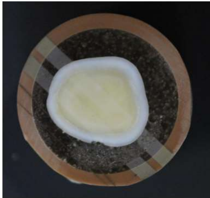
Figura 6 – Espécime amostral incluído em resina acrílica e com duas regiões distintas irradiadas pelo laser Ti:Sapphire femtosegundo.
