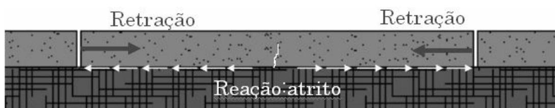
Figura 10: Formação de fissura por retração (Fonte: MAGGI, 2006).
