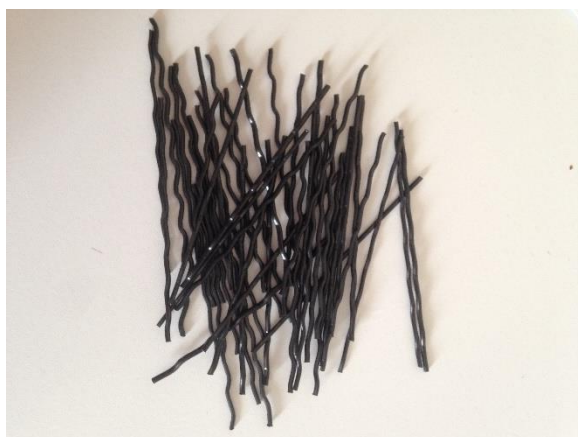
Figura 5 - Macro fibras de polipropileno
