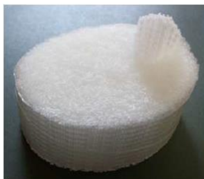
Figura 3 - Fibra de polipropileno em forma de novelo (PORTAL DA ARQUITETURA E CONSTRUÇÃO)
