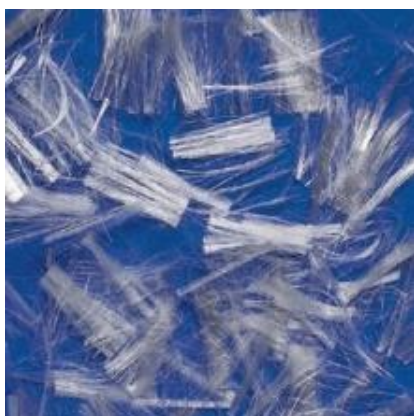
Figura 4 - Fibras de polipropileno (PORTAL DA ARQUITETURA E CONSTRUÇÃO)
