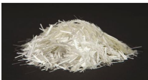
Figura 7 - Fibra de vidro (PORTAL DA ARQUITETURA E CONSTRUÇÃO).
