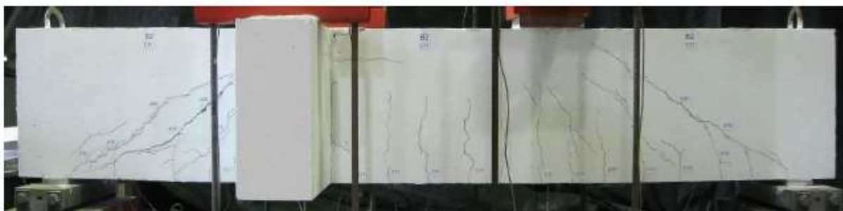
Figura 74 - Viga B2 após o pico de carga de 392 kN
