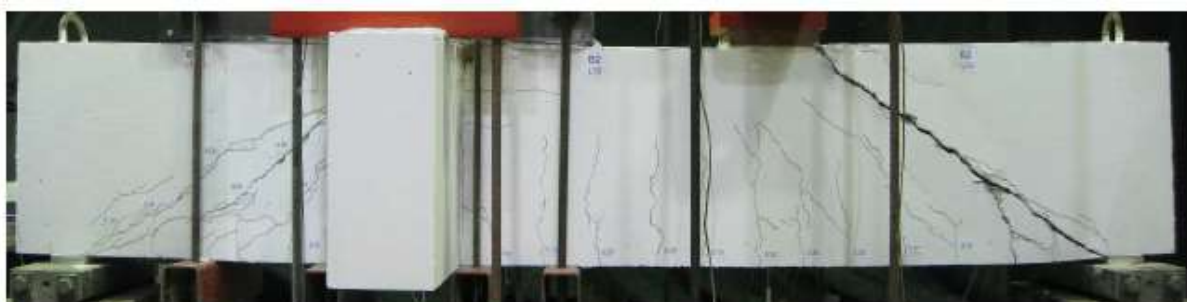
Figura 75 - Viga B2 após o pico de carga de 480 kN
