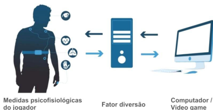
Figura 63 - Esquema da arquitetura do sistema FUNii
