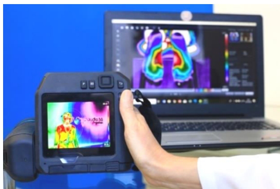
Figura 43 - Imagem termográfica na câmera e no computador
