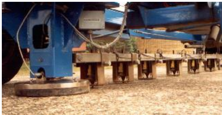
Figura 5 - Sensores de Medida de Deflexão
