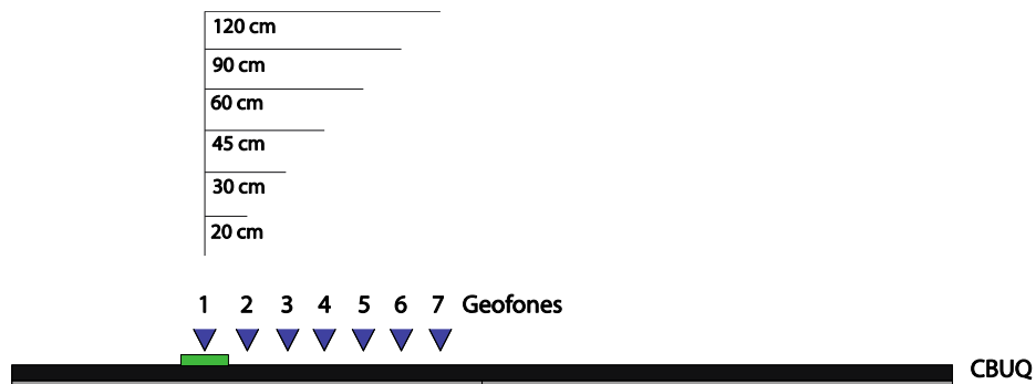
Figura 14 - Esquema de Execução do Levantamento Deflectométrico
