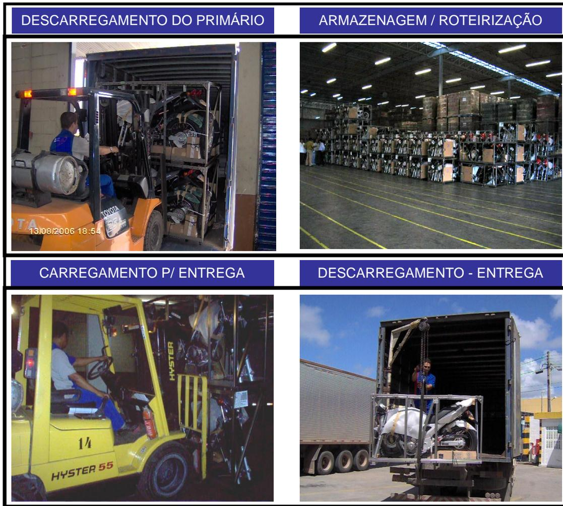
Figura 4.4 – Fluxo de operação com motos desmontadas.
