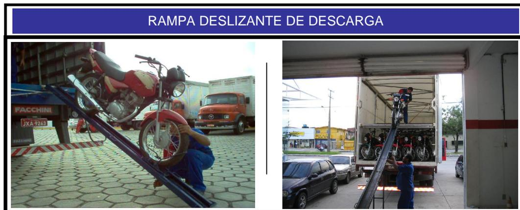
Figura 4.9 – Rampa deslizante de descarregamento.
