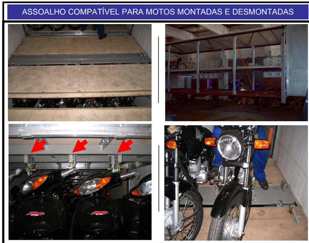
Figura 4.7– Assoalho compatível para motos montadas e desmontadas.
