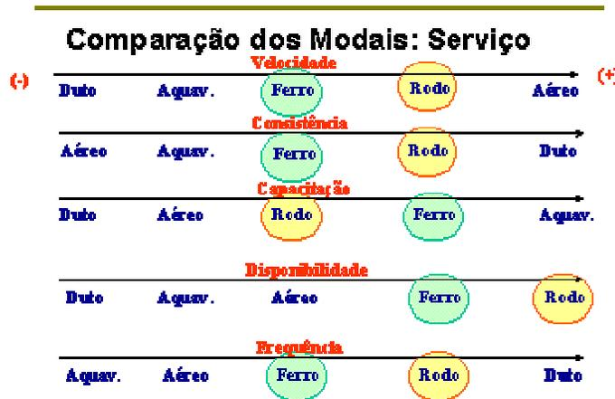
Figura 2.1 – Comparação dos modais em termos das dimensões de serviço
