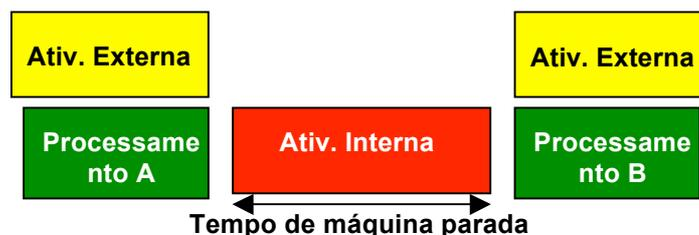
Figura 2.7 – Racionalização do setup interno e externo (o autor, 2008).
