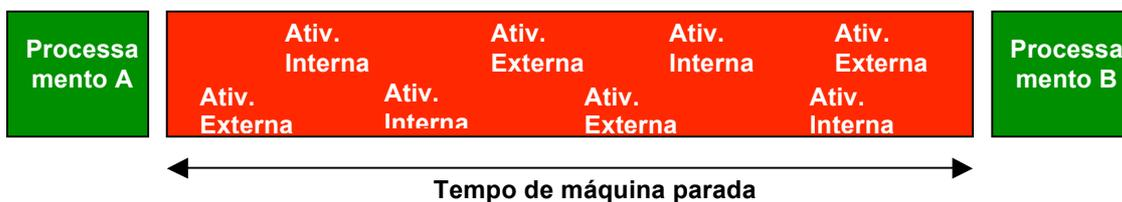
Figura 2.4 – Setup interno e externo não se distinguem (o autor, 2008).
