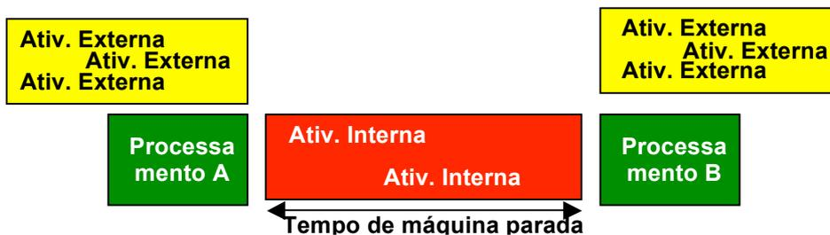
Figura 2.6 – Conversão do setup interno em externo (o autor, 2008).
