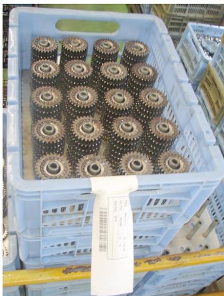
*Figura 4.8. – Caixa de peças identificada com etiqueta de código de barras*
