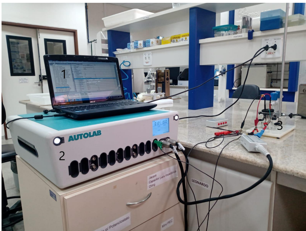
Figura 11 - Sistema utilizado na polimerização da anilina composto por: (1) computador, (2) potenciostato e (3) célula eletroquímica.
