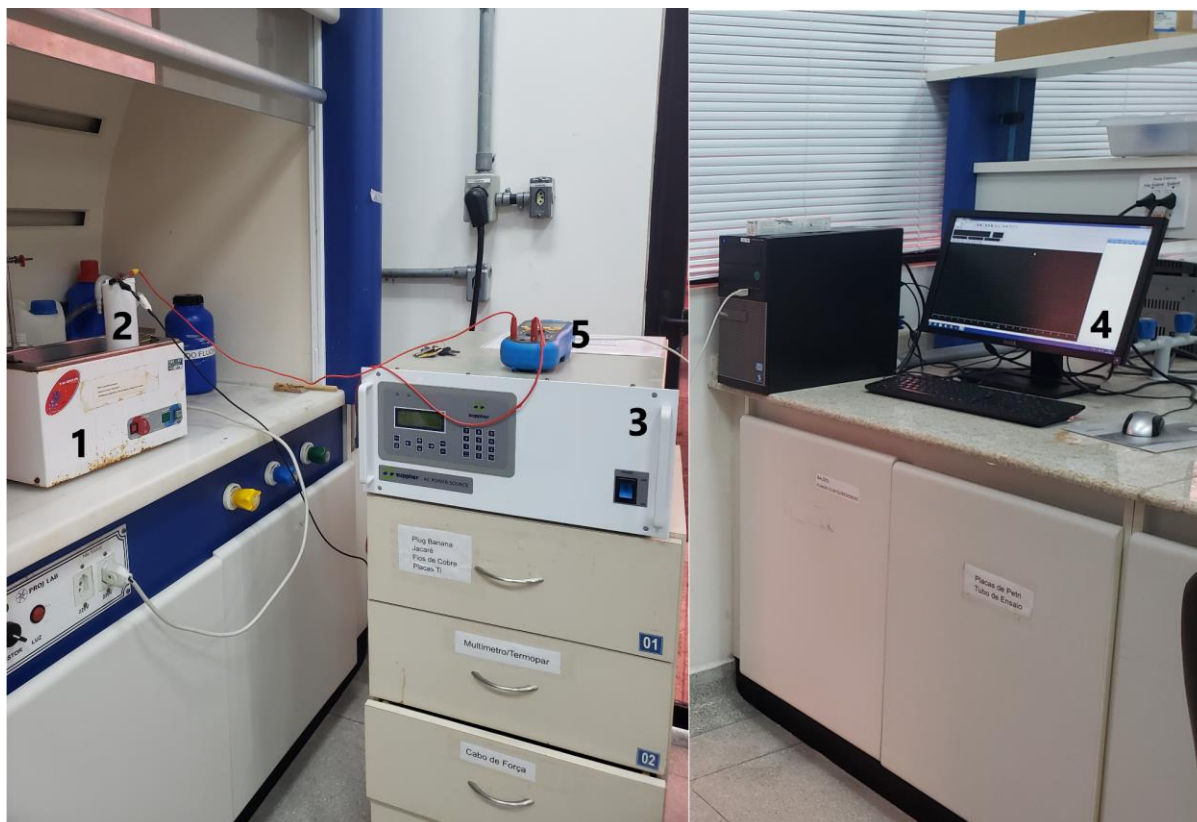
Figura 10 - Esquema experimental utilizado na anodização, composto por: (1) ultrassom, (2) reator eletroquímico, (3) fonte de tensão, (4) computador e (5) multímetro.
