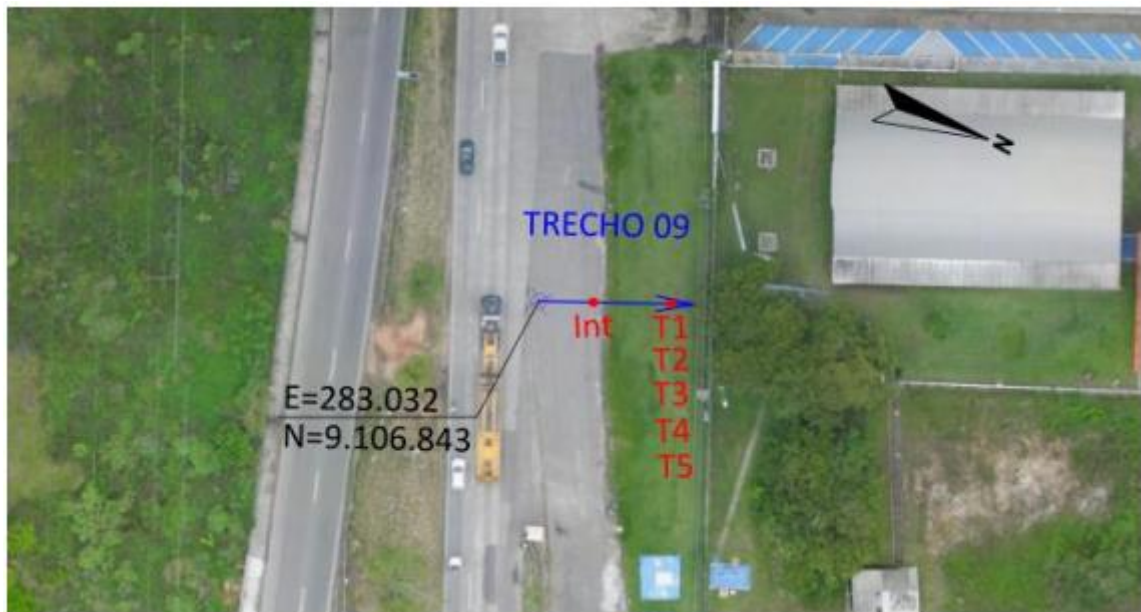
Figura 40 – Trecho 09 do levantamento por GPR
