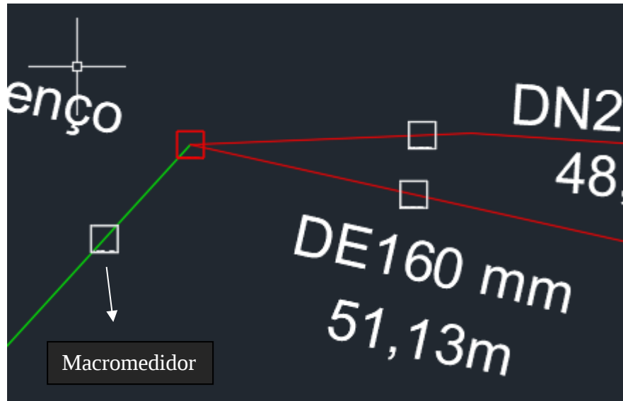
Figura 9 – Trecho de rede de abastecimento de água projetada para o município de Goiana/PE, contendo macromedidores em formato de bloco no AutoCAD .
