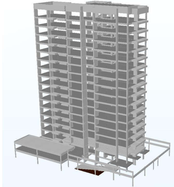
Figura 22 – Modelo estrutural do empreendimento
