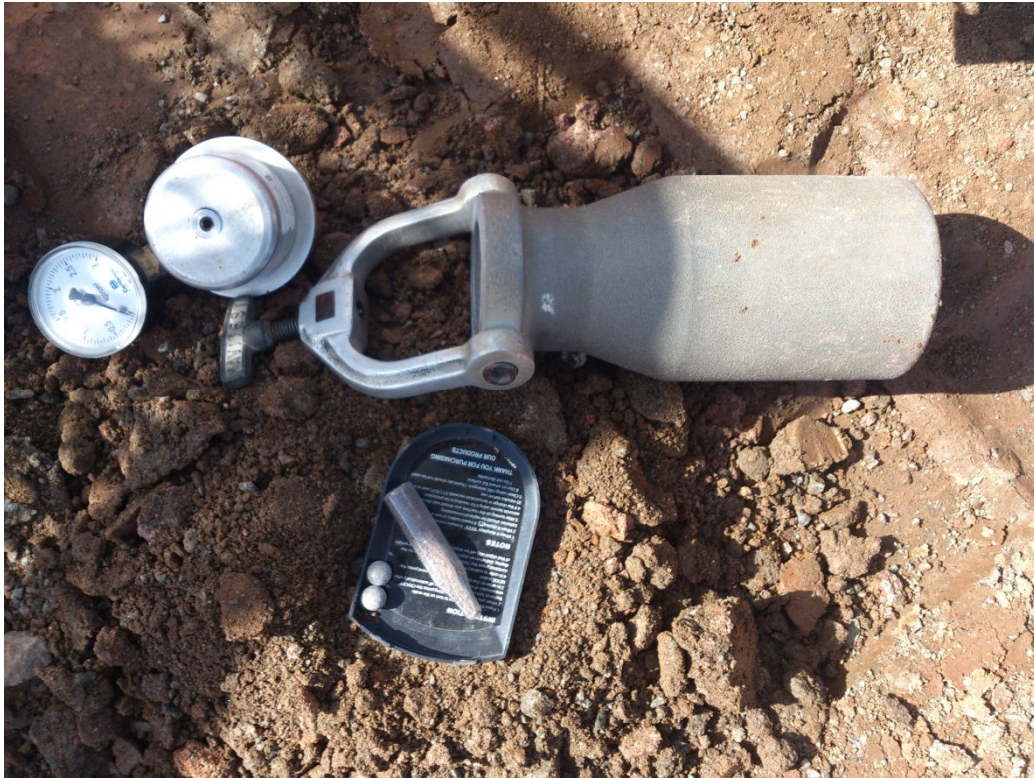
Figura 12: Instrumentação do ensaio de Speedy, realizado para definir a umidade do solo.
