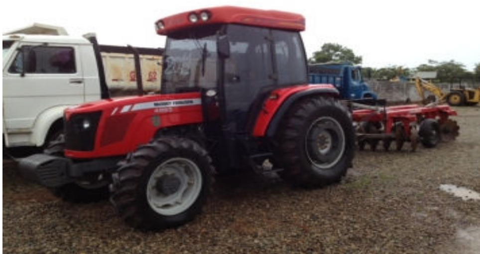
(A) Figura 2: Trator de Pneus com grade de discos.
