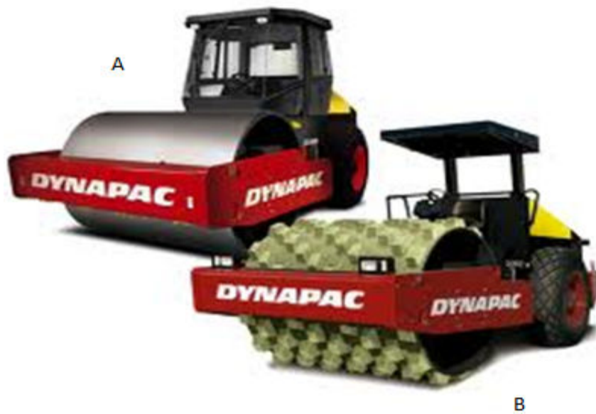
(A) Figura 4: A rolo compactador liso, B rolo compactador pé-de-carneiro,
