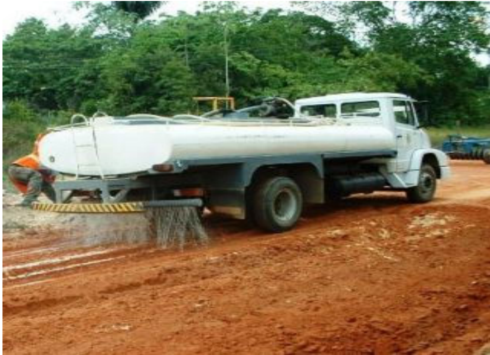
(A) Figura 3: Caminhão pipa com distribuidor de água.
