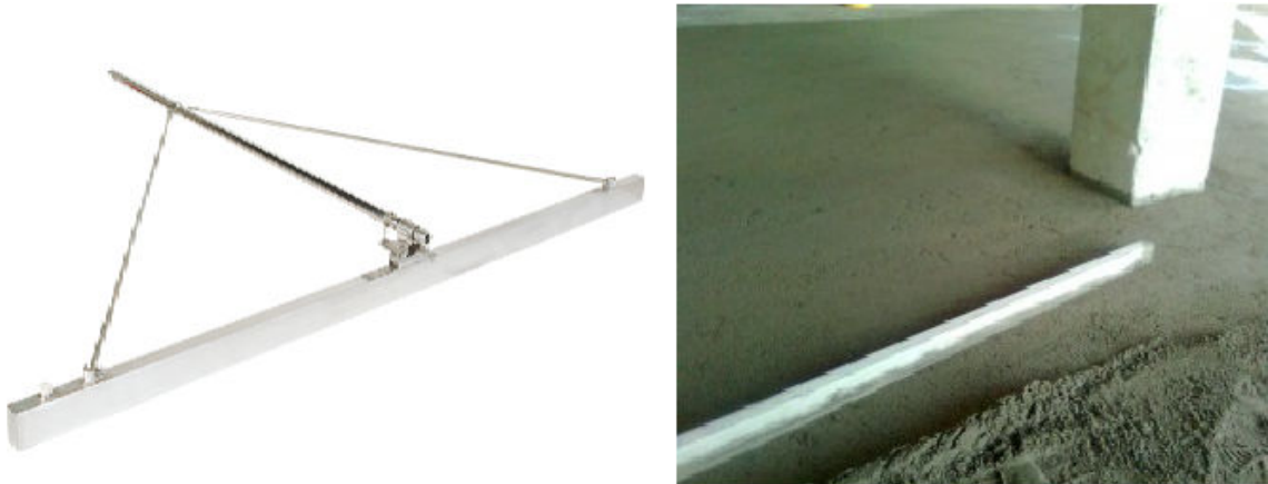
Figura 35: Rodo de corte e régua de alumínio em detalhes.
