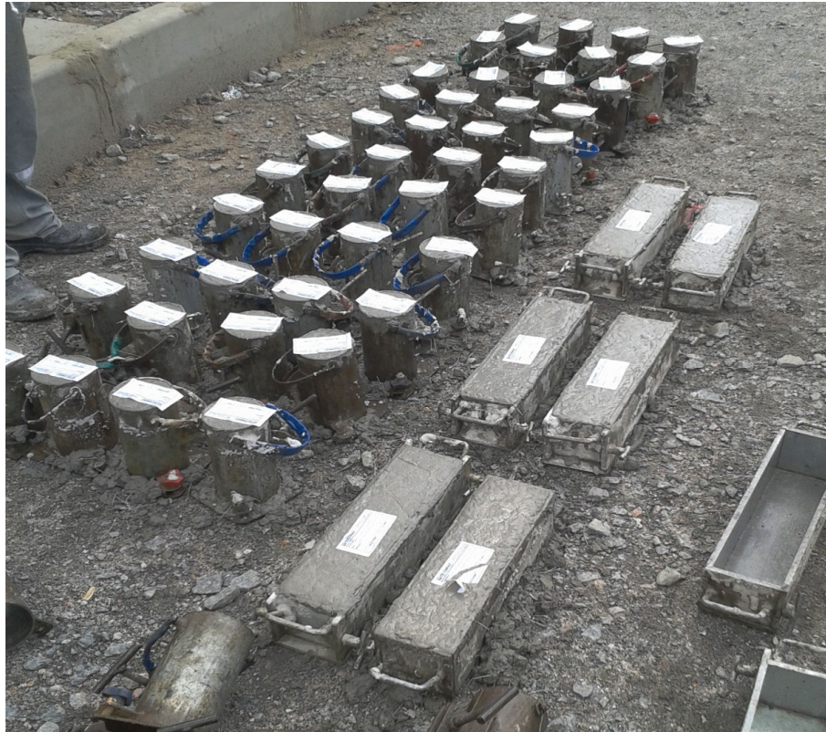
Figura 32: Moldagem de corpos-de-prova, cilíndricos e prismáticos.
