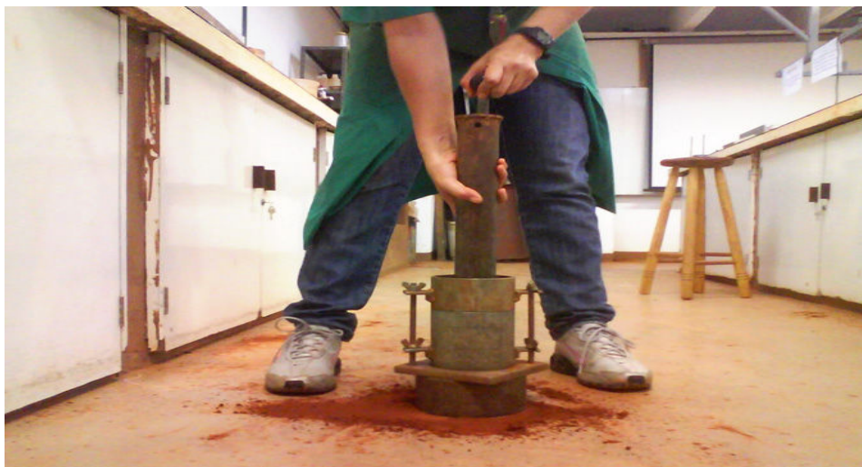
Figura 1: Realização de ensaio de Proctor Normal.
