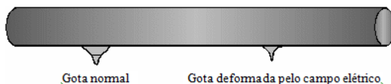
Figura 9 – Deformação de uma gota de água sob ação de um campo elétrico de um condutor
