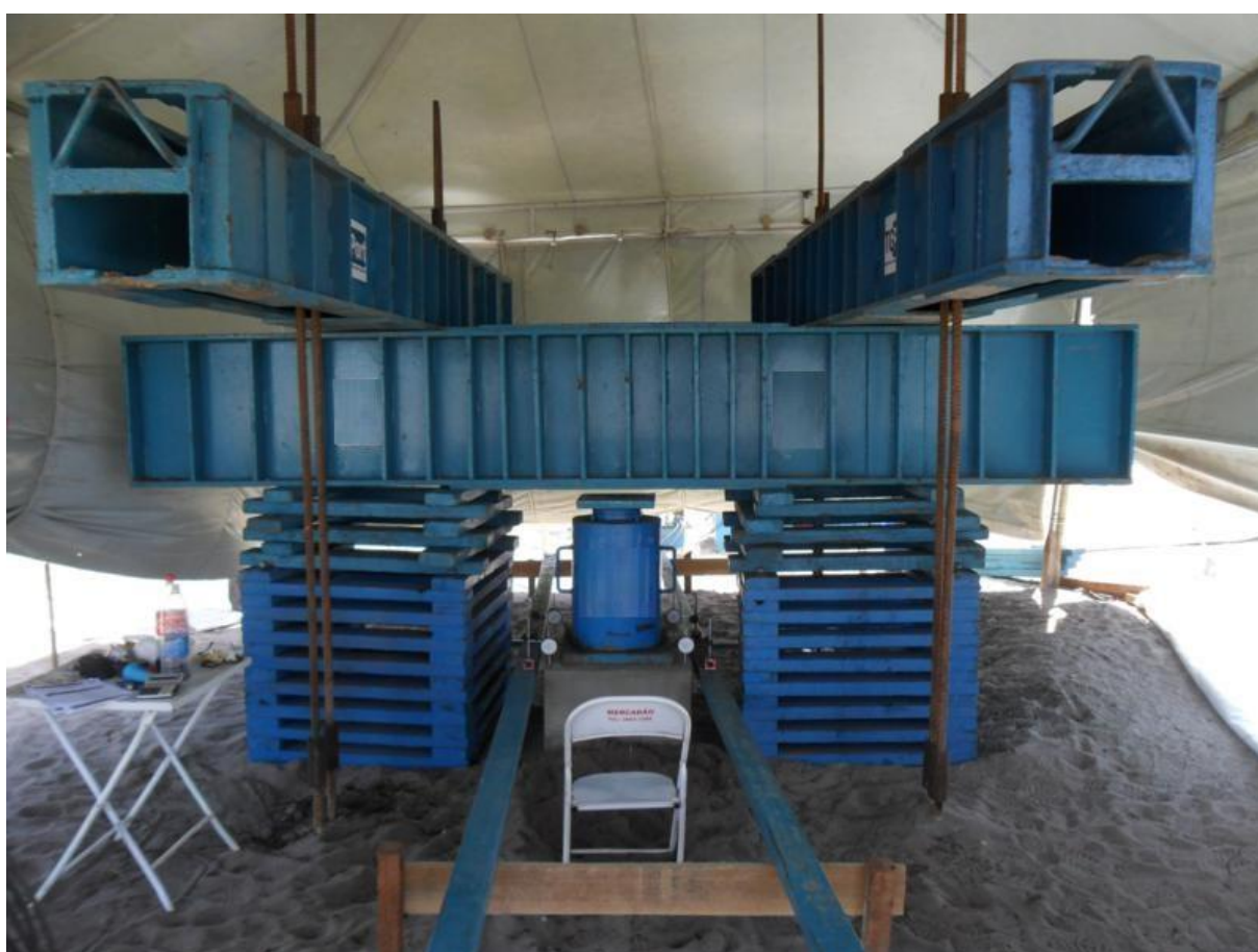
Figura 2.6 – Exemplo de prova de carga estática com sistema de reação em estacas (2)
