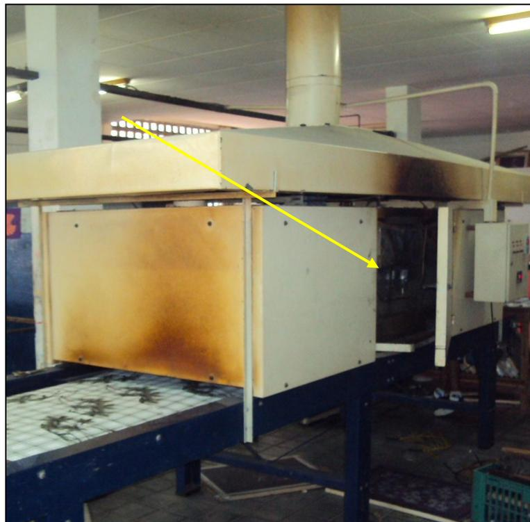
*Fotografia 3.6 – Secadora de esteira exibindo a chama acesa*
