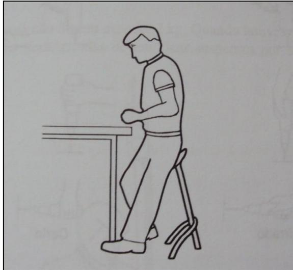
*Figura 5.2 – Selim de apoio para posição semi-sentada*
