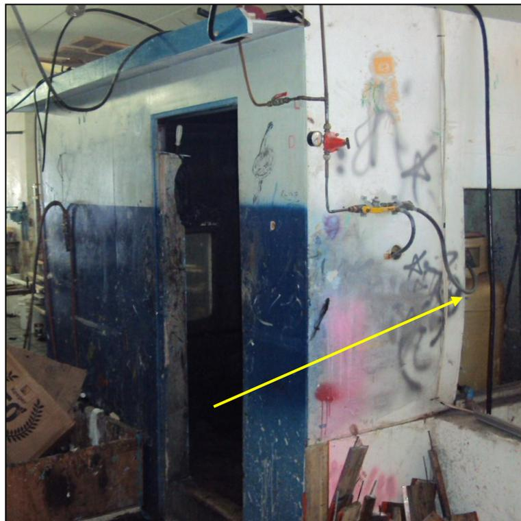
Fotografia 3.2 – Célula de revelação e lavagem com cilindro de ar pressurizado
