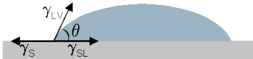
Figura 2 - - Representação do ângulo de contato entre o líquido e uma superfície plana horizontal e as respectivas tensões sólido-vapor ( \gamma_S ), sólido-líquido ( \gamma_{SL} ) e líquido-vapor ( \gamma_{LV} )
