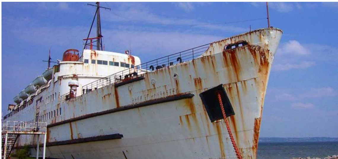
Figura 8 - Corrosão em embarcação.
