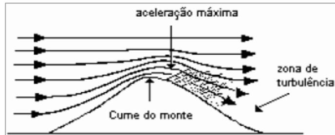
**Figura 3.1 - Aceleração do vento sobre uma elevação**
