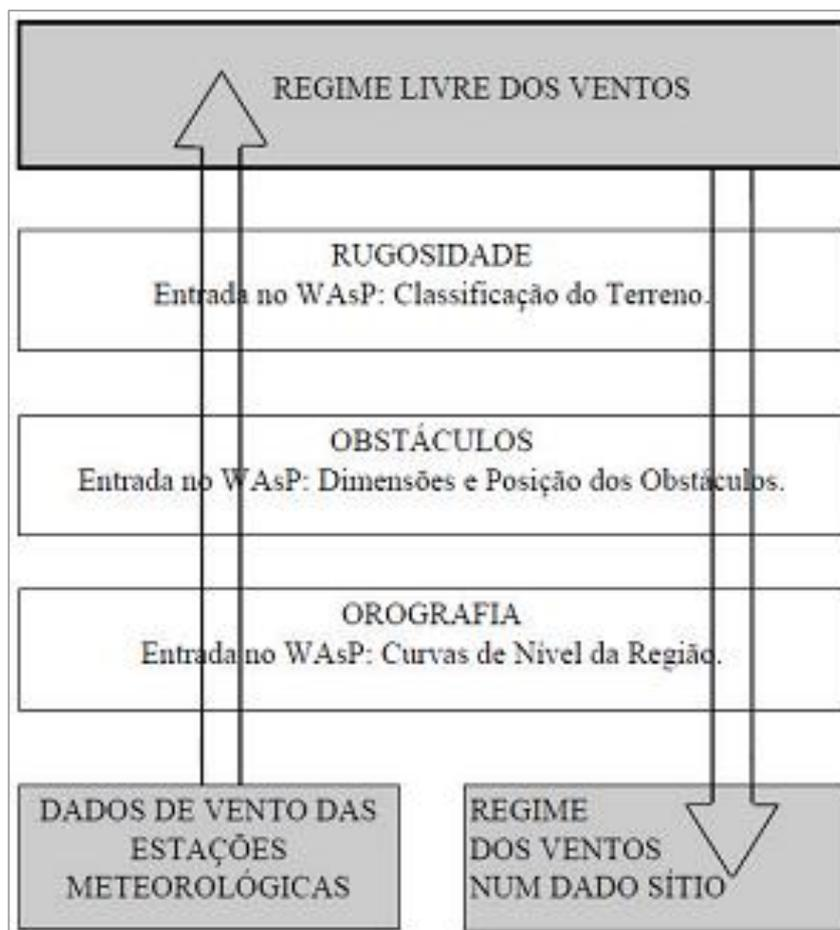
**Figura 3.13 - Princípio de funcionamento do programa WAsP**
