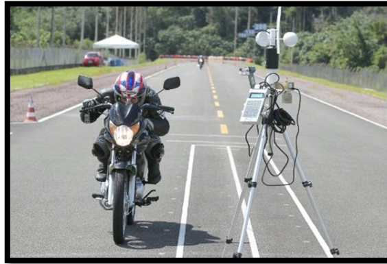
Figura 13 - Motocicleta realizando o ensaio de ruído
