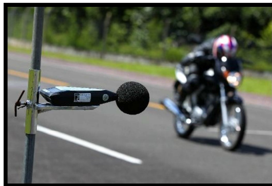
Figura 14 - Ensaio de ruído – decibelímetro no detalhe
