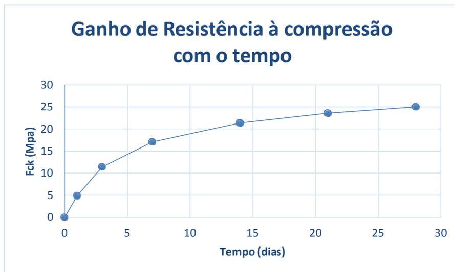
Figura 2.10 – Resistência à compressão x tempo
