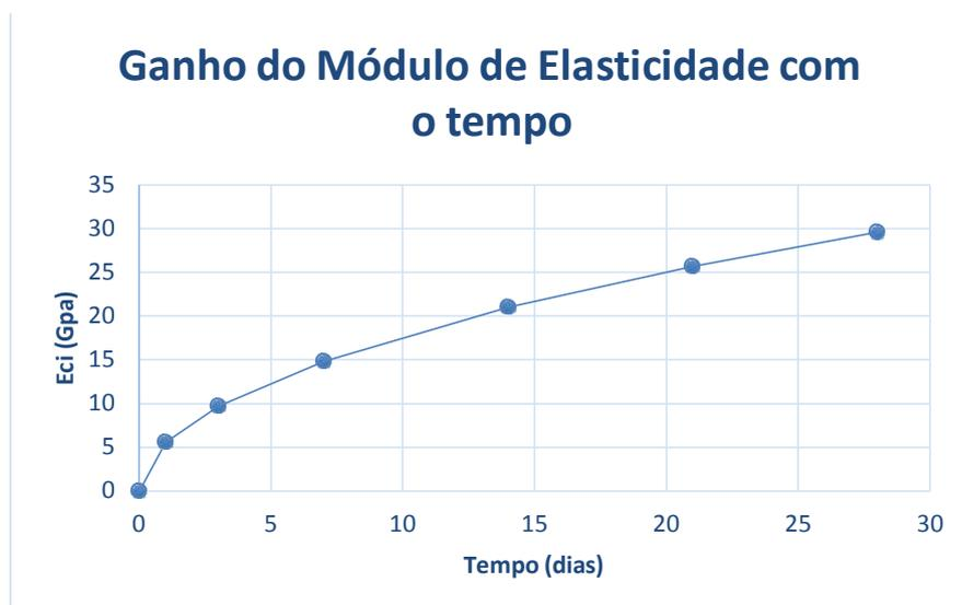
Figura 2.11- Módulo de elasticidade x tempo (concreto)
