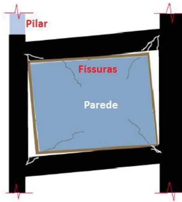
Figura 2.5 - Efeitos de recalque diferencial em uma estrutura.
