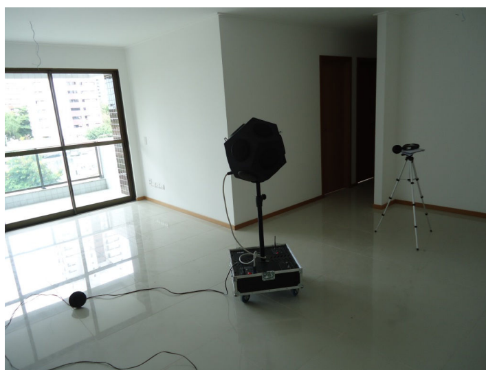
Foto 5 - Medição do tempo de reverberação em quarto
