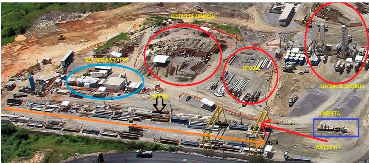
Imagem 2: Área de fabricação dos pré-moldados no canteiro de obra.
